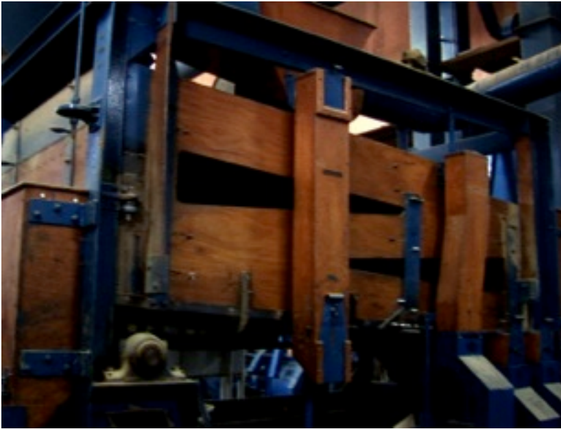
Mehrstufiges Sieb bei der Firma CAMEC in Guatemala-City
